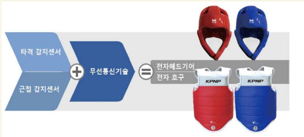
[그림2] 전자호구 시스템 구성요소
